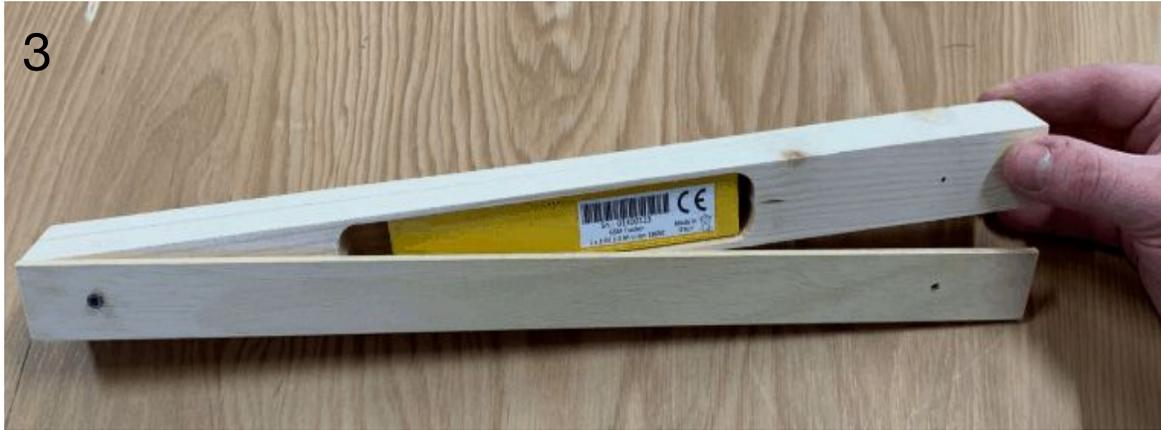
Insérez le l'appareil GPS par le bas de sorte qu'il soit alors orienté vers le haut..
