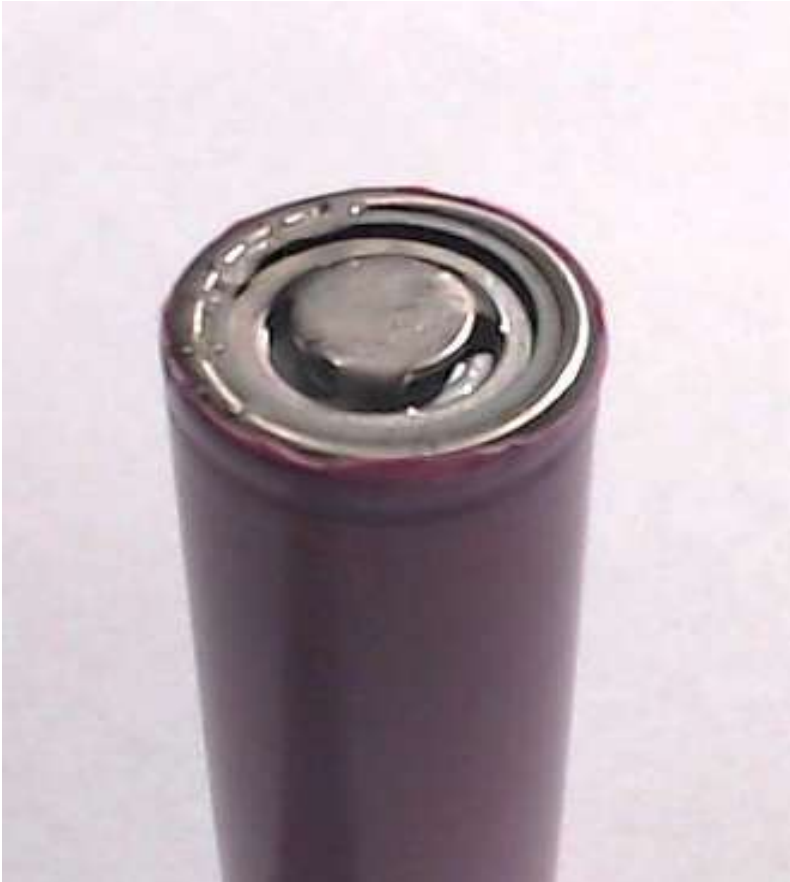
Isolamento danneggiato – Non Utilizzare
