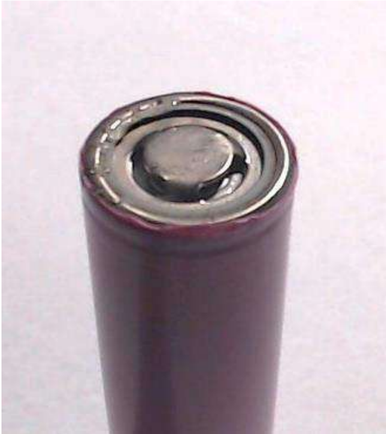
Aislamiento dañado – No utilizar
