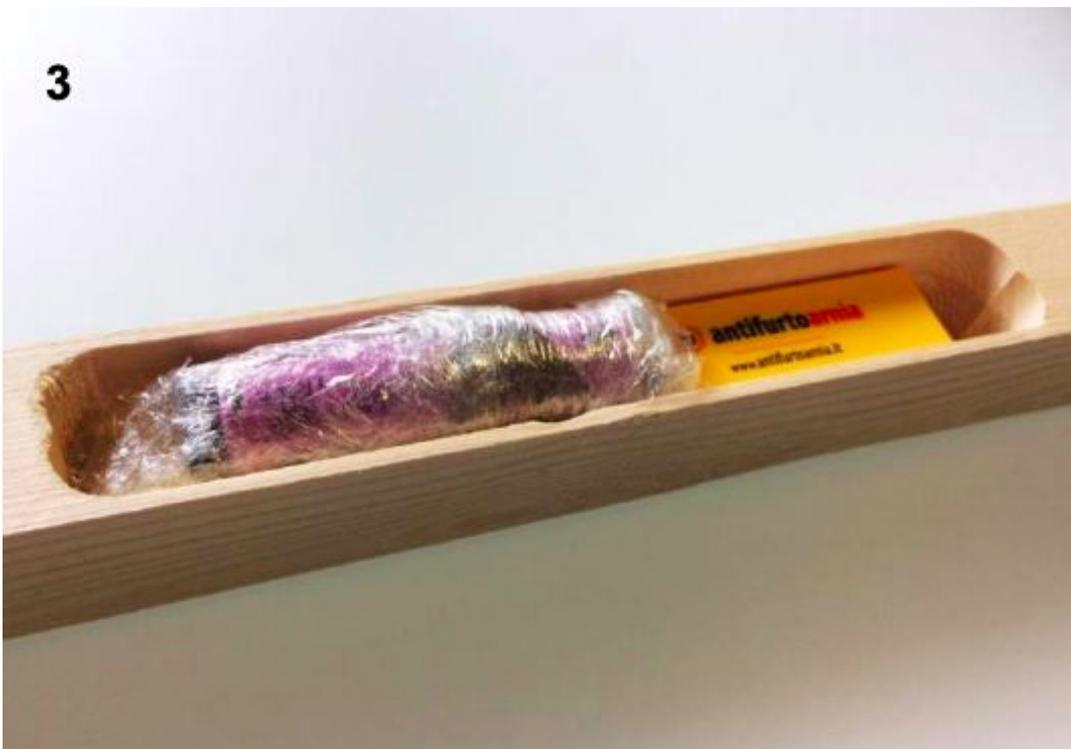
Setzen Sie den Halter mit dem Gerät in die Unterseite des Rähmchens ein und ziehen Sie die seitlichen Schrauben wieder fest
